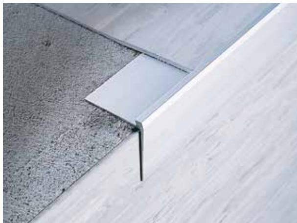
STAIRTEC SC sont des nez de marches conçus pour la finition des marches revêtues de matériaux résilients. Pour la pose, appliquer le revêtement sur la contremarche et installer le profil en le fixant au support. Procéder à la pose du revêtement sur le plat de marche, au-dessus de l'ailette d'ancrage du profil. Le bord du revêtement résilient sera ainsi encadré et bien protégé par la petite saillie verticale débordante du nez de marche et la contremarche en sera préservée durablement.
